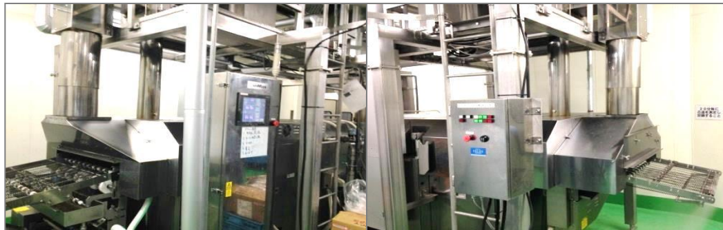
過熱蒸気式バンドオープン（焼き、蒸し、乾燥、煮物加工）
